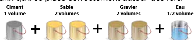
Formule de béton type pour les fondations
