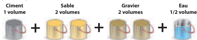
Formule de béton type pour les fondations
