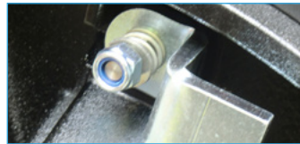
6 Mettre en place le pêne, le ressort, la rondelle Ø 12 mm et l'écrou. Serrer l'ensemble avec une clé de 19
